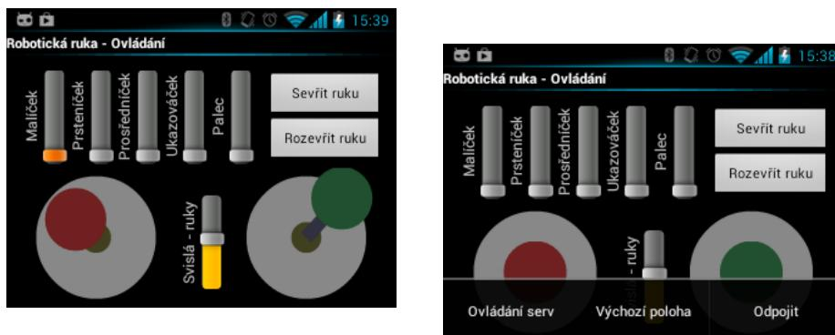
Obrázek 24: Ovládací okno android aplikace
