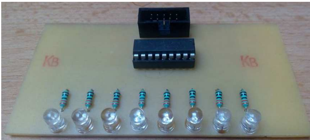
Obrázek č. 12: Fotografie modulu s LED diodami
