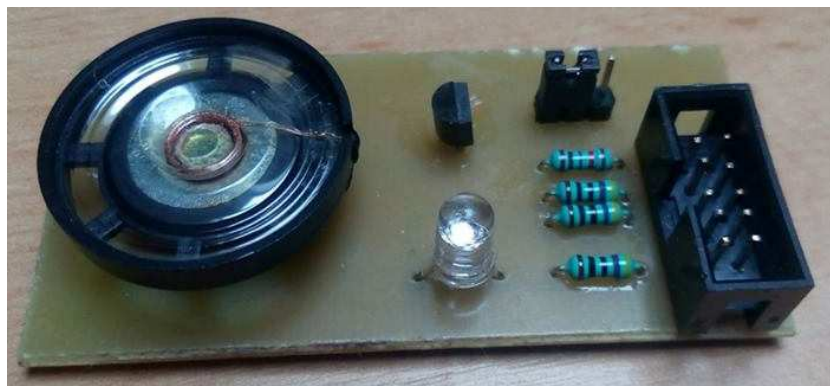
Obrázek č. 33: Fotografie modulu s reproduktorem + RGB LED diodou
